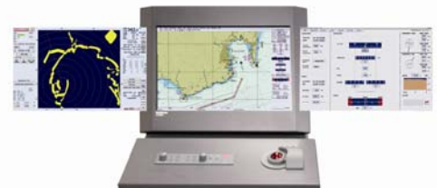
Multifunktionsbildschirme stellen der Schiffsführung verschiedene Funktionen wie zum Beispiel Radar, ECDIS oder Conning an jedem Arbeitsplatz der Integrierten Brücke zur Verfügung.
